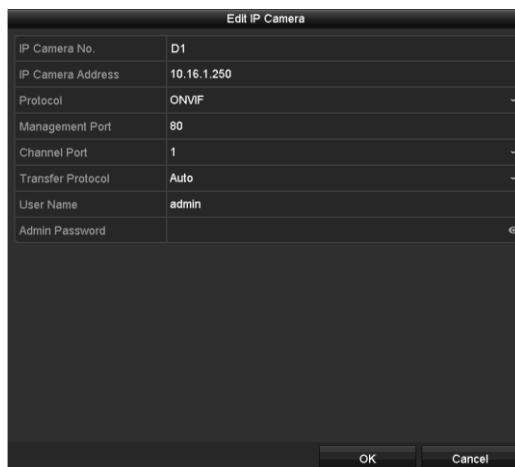
Obrázek 2–45 Úprava IP kamery
